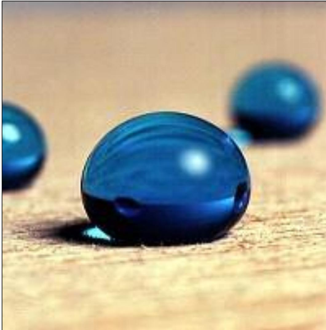
L'ampiezza dell'angolo di contatto (ovvero la rotondità della goccia deposta sulla superficie) testimonia l'elevata repellenza della superficie.
